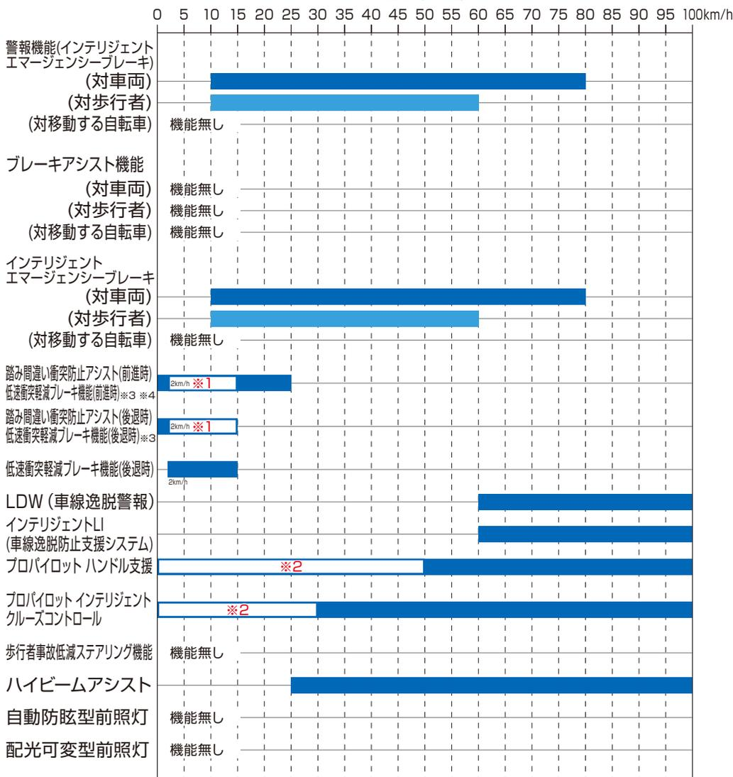
※1 □部分は、低速衝突軽減ブレーキ機能作動速度。
